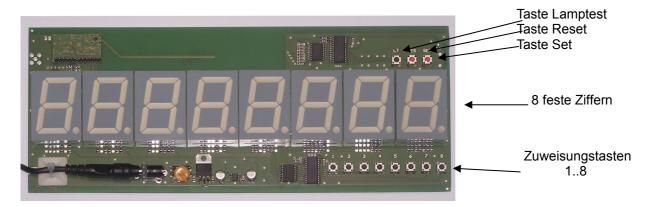
Das FRT-8 N ist eine Empfangseinheit mit 8 festen Ziffern. Pro Ziffer sind 2 Speicherplätze vorgehalten. Mit einem Sender kann eine Ziffer aktiviert und mit einem weiteren Sender die Anzeige gelöscht werden. Die Anzeigen der einzelnen Stellen sind fest verdrahtet und können nur angesteuert werden.
