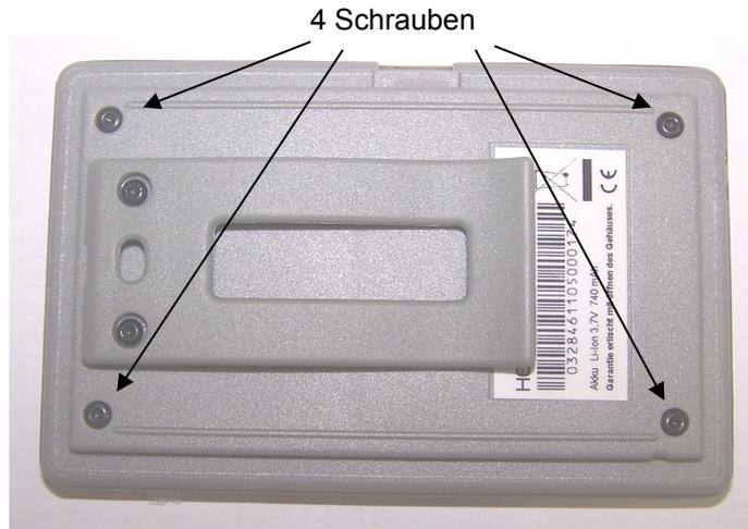
Nach dem Lösen der 4 Schrauben muss der Deckel parallel angehoben werden.
