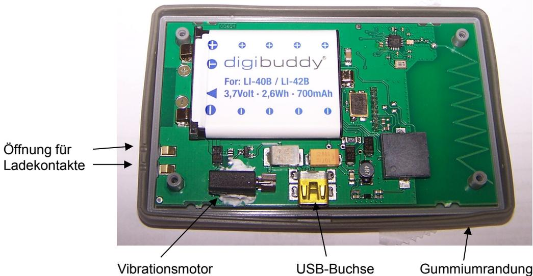
Zum Verschließen ist es zweckmäßig, die Gummiumrandung in die Nut des Oberteils zu legen. Danach wird der Deckel parallel auf das Oberteil gelegt. Es ist auf eine Zentrierung der Führung für den Vibrationsmotor zu achten, um ein Verschieben zu vermeiden. Der Boden darf nur mit leichter Kraft auf das Oberteil gedrückt werden. Ist ein Widerstand zu spüren, so ist der Vibrationsmotor nicht richtig zentriert.
